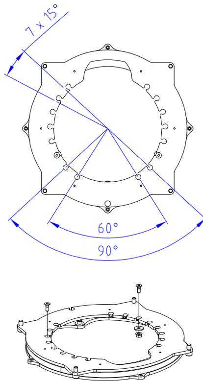
Verbrennungsluft kann durch Boden zugeführt werden
